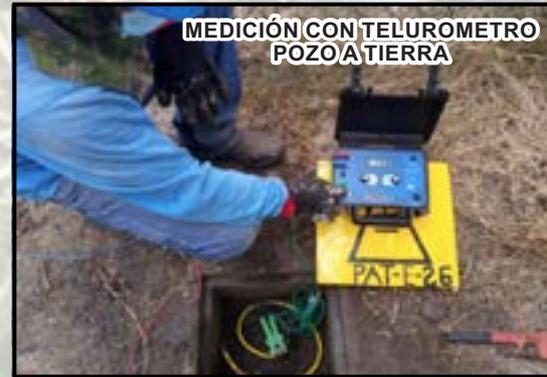
MEDICIÓN CON TELUROMETRO POZO A TIERRA
